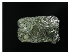
图 8.3 用锡纸包裹样品膜
