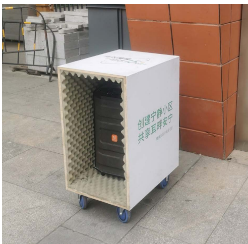
图 5-5 福建省厦门市某小区音响设备简易隔音箱
