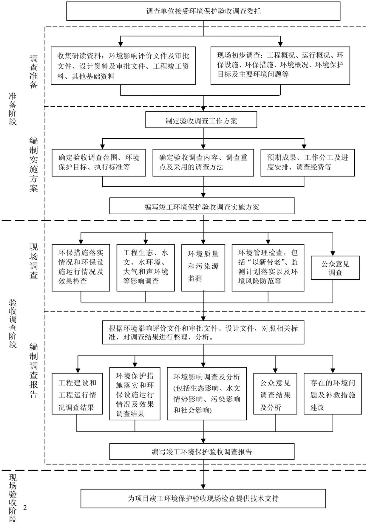
图 1 水利水电建设项目竣工环境保护验收技术工作程序
